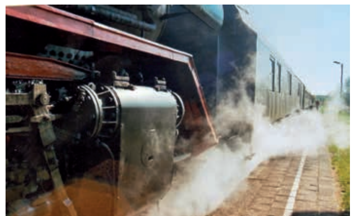
Das mächtige Triebwerk einer DR-Schnellzuglok der Baureihe 03
