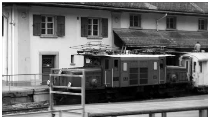
Vor dem Museum der Albulabahn in Bergün steht eines der letzten „rhätischen Krokodile“, eine Elektrolok der Baureihe Ge 6/6 I, Baujahr 1922, Foto: Venz
