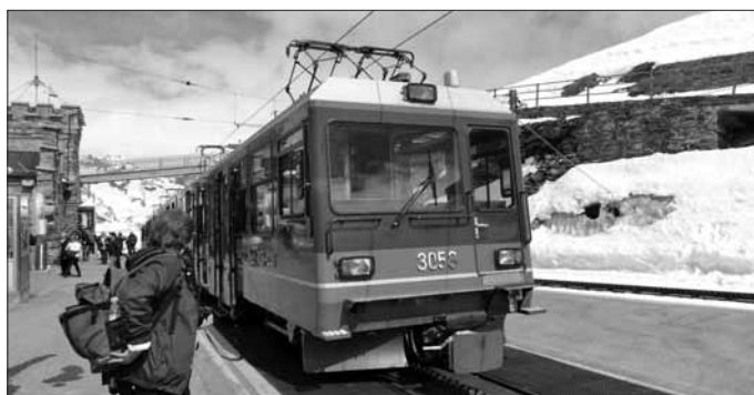
Die Gornergratbahn (GGB), in Zermatt, ist eine elektrisch betriebene Zahnradbahn und erreicht am Endbahnhof 3089 m.ü.M. Sie ist damit die zweithöchste Bergbahn Europas. Im Bild ist ein Triebwagen Bhe 4/8 mit der Betriebsnummer 3053 zu sehen, Foto: Venz
