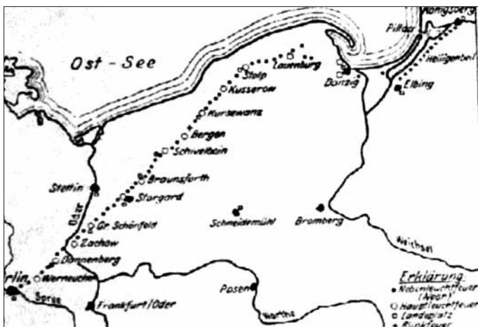
Übersichtskarte der Nachtflugstrecke Berlin-Königsberg, die 1927 mit großem Aufwand in Betrieb genommen wurde. Verzeichnet sind alle Glühlampendrehfeuer und -blickfeuer, die die Orientierung der Piloten in der Nacht erleichtern sollten.
