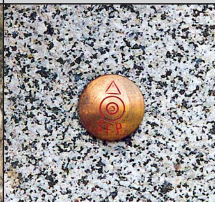
SFP Messingbolzen Ø 3 cm
