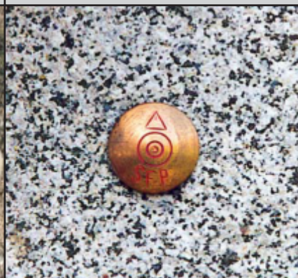
SFP Messingbolzen Ø 3 cm
