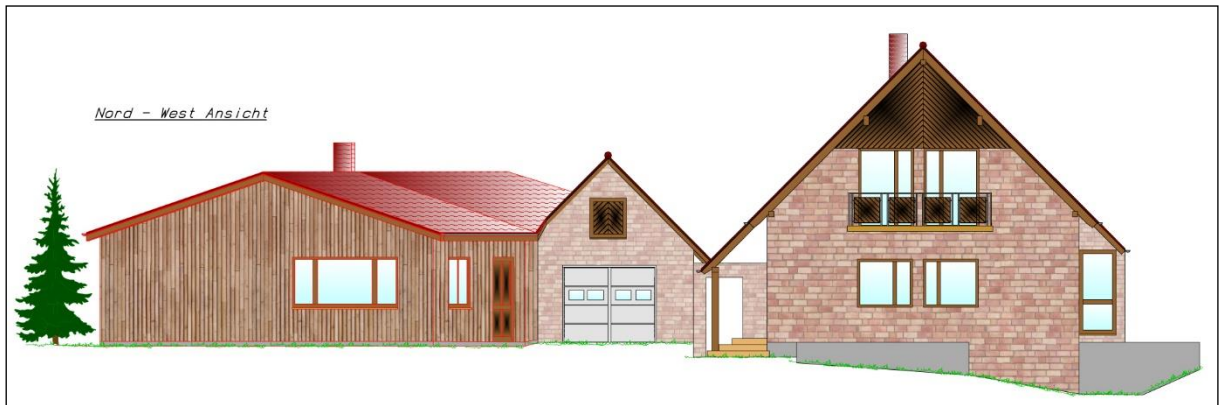
Abbildung 5 Ansicht des bestehenden Wohnhauses mit angrenzender Garage (rechts) sowie daran unmittelbar anbindend die geplante Tischlereiwerkstatt (links)
